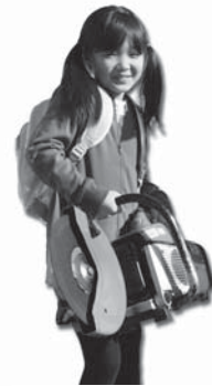
▲エンジンカッター 金属を切断するカッター。シャッターなど救助の妨げになるものを切断します。
