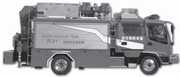
▲特殊工作車両 災害発生時に救助に役立つ様々な機械・道具を搭載した車両です。
