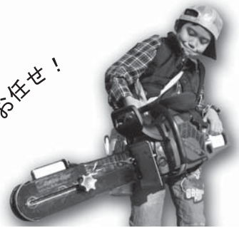
▲カッターエッジチェーンソー 救助専用チェーンソー。柱などに含まれる釘や金物の金属も木材と一緒に切れます。
