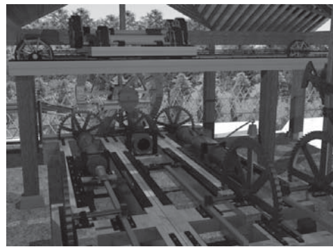
鋳台での鑽開作業 (CGによる復元想像図)
