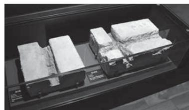
反射炉に使用された耐火煉瓦
