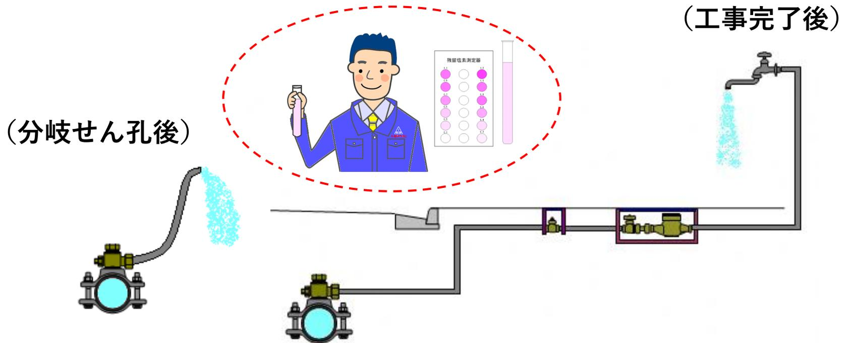
※ 残留塩素濃度の測定は、取出し工事の際には分岐部において、工事完了後は末端給水栓において行い、水道水であることを確認する。
