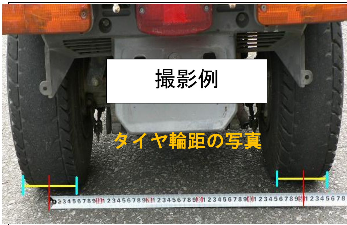
写真2 輪距又は車体形状等がわかるようにスケール（メジャー）をあてた写真（拡大）
