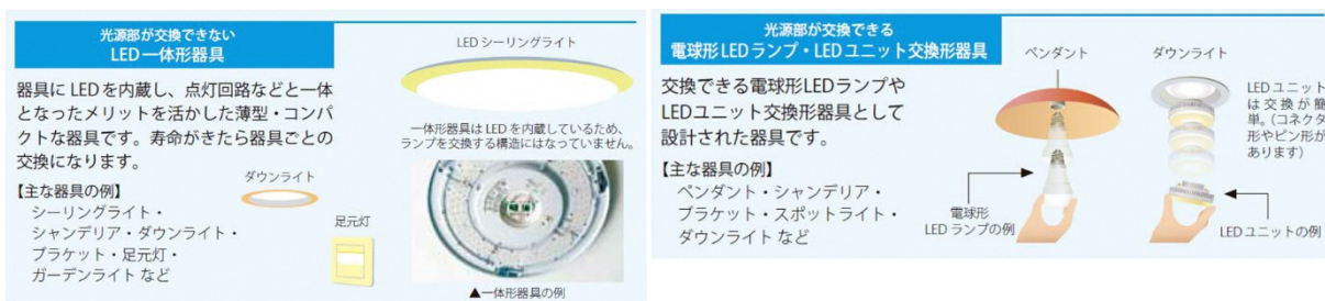
図2. 一般家庭用のLED 照明のタイプ 4
