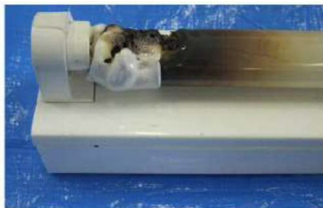
図 9. 直管 LED ランプの損傷例
