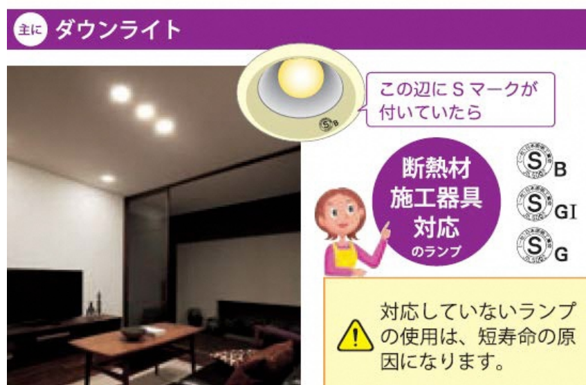
図 7. 断熱材施工器具対応のタイプの例 11
