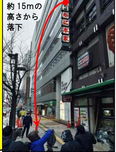
2015年2月、札幌市内の飲食店ビルの外壁に取付けられた看板の一部が落下し、歩道を通行していた女性の頭部に当たり重傷を負わせる事故が発生しました。外壁への取付け部品が腐食したことによって強度が低下し、強風の影響で落下したものとみられています。
